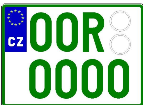
rozměr 330 x 85 mm (jen ze samolepící folie)
